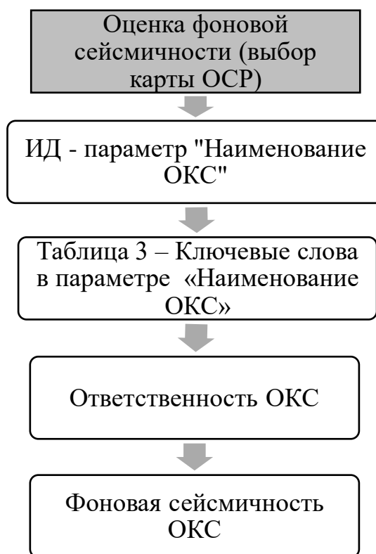
Рисунок 8 – Блок–схема оценки фоновой сейсмичности
