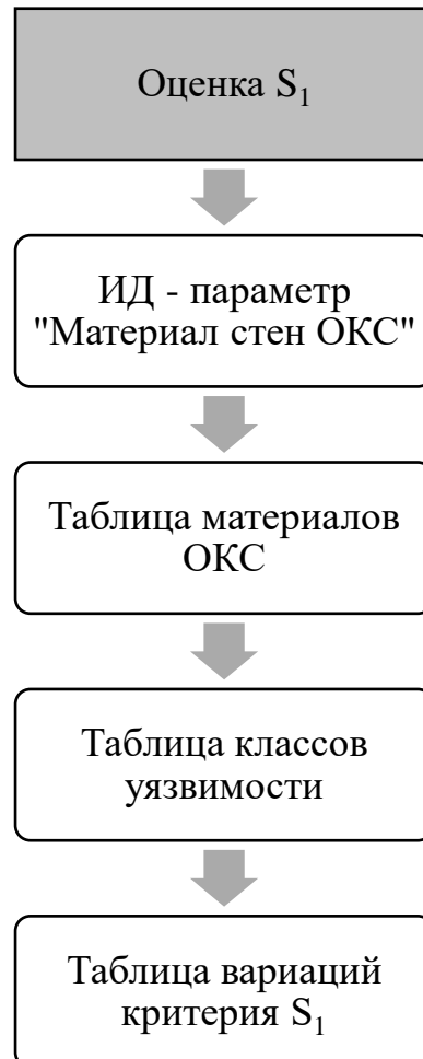
Рисунок 10 – Блок-схема оценки критерия S_1
