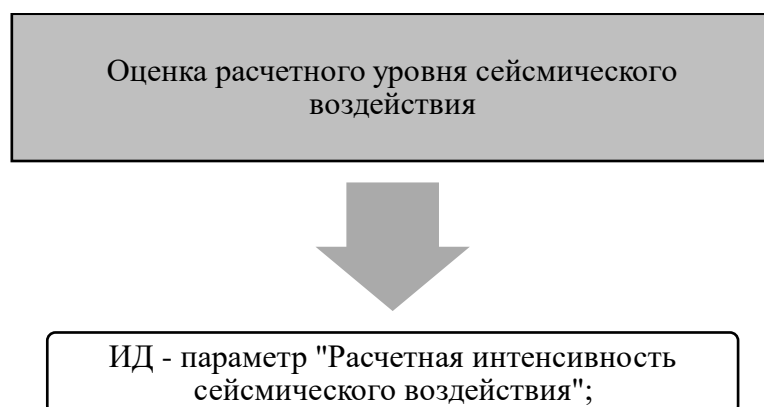
Рисунок 14 – Блок–схема оценки расчетного уровня сейсмического воздействия
