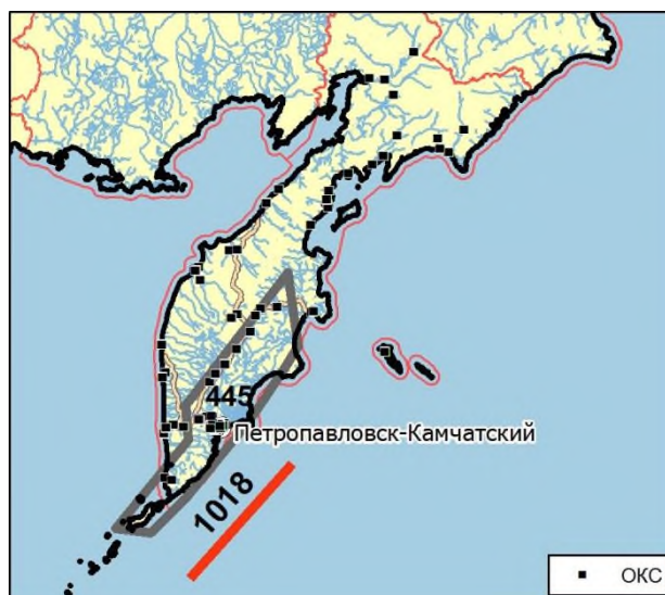
Рисунок 172 – Линеаменты, обеспечивающие максимальный разовый ущерб ОКС Камчатского края
