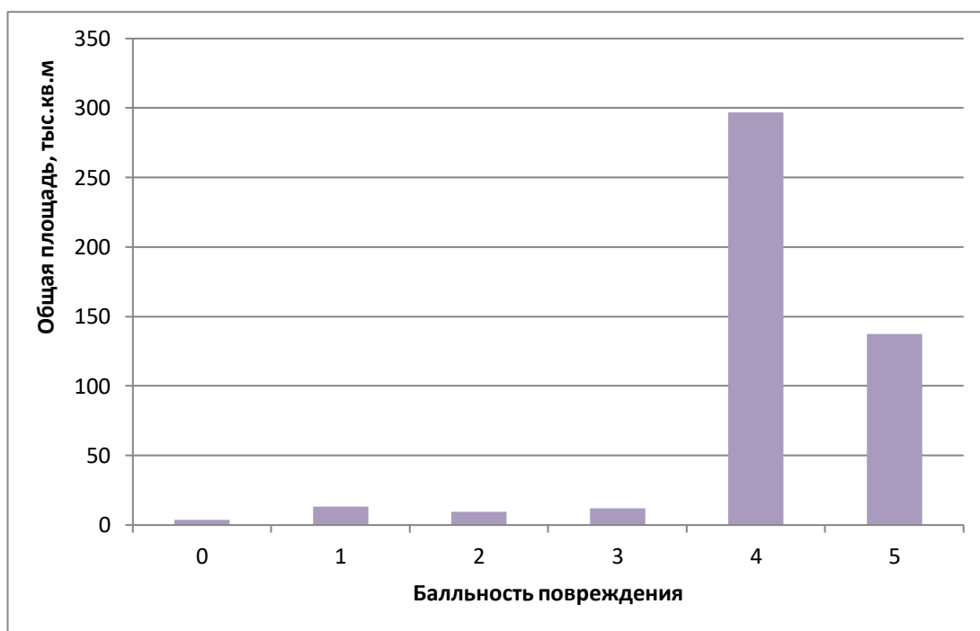
Рисунок 166 – Количество жилой площади в соответствии с балльностью повреждения
