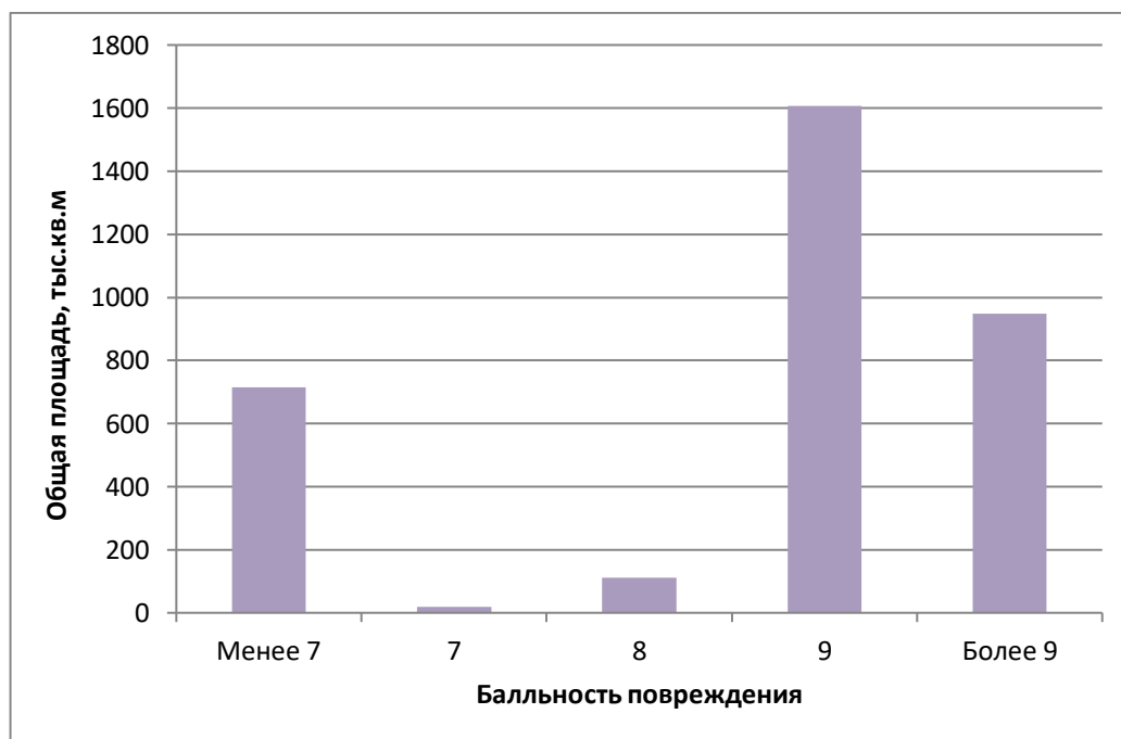
Рисунок 199 – Количество жилой площади в соответствии с балльностью повреждения
