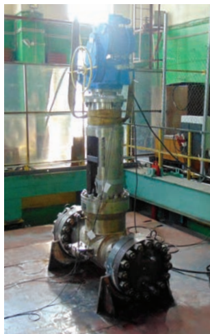
Сейсмоплатформа «УСВС-100»: испытания на сейсмостойкость вантуза нефтепровода (слева) и задвижки DN300 (справа)
