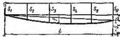
Рис. 10. Схема сложной деформации основания i = (s_6 - s_1) / L - крен, f / L - относительный прогиб сооружения
