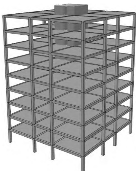
Рисунок В.7 – Общий вид и расчетная схема конструктивной системы
