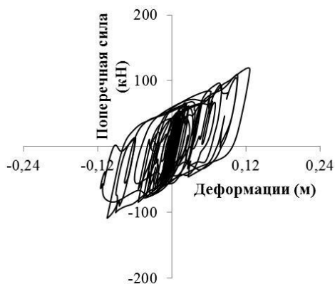
Г2.32-сурет – TCU089 жасанды акселерограммаларымен берілген "1" сейсмикалық әсерлердің комбинациясы кезінде ғимараттың бойлық (а) және көлденең (б) бағыттарындағы сейсмикалық оқшаулағыш эластомерлік тіректердің әрекетін сипаттайтын тәуелділіктер
